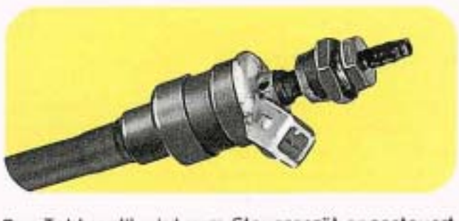
Das Taktventil wird vom Steuergerät angesteuert und dadurch geöffnet und geschlossen. Dadurch wird der Kraftstoffdruck in den Unterkammern des Mengenteilers ständig den Erfordernissen angepaßt.
